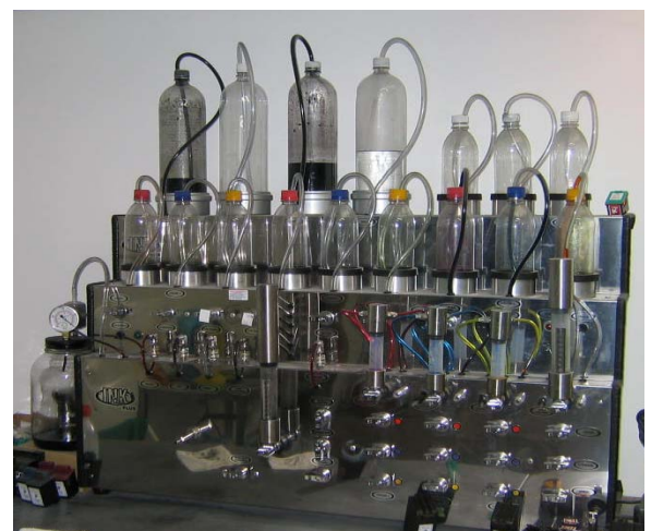
Fig. 4- Equipamento de enchimento dos tinteiros
