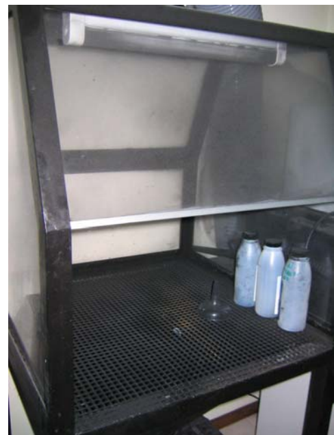
Fig. 2- Cabina de regeneração dos cartuchos de toner
