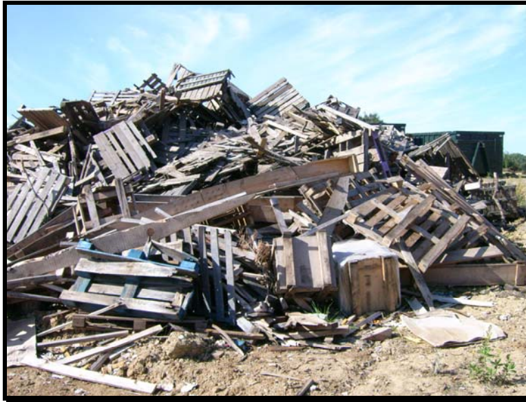
Figura nº 6 – Material estruturante para ser utilizado na compostagem de lamas de depuração, carecendo ainda de ser fragmentado.
