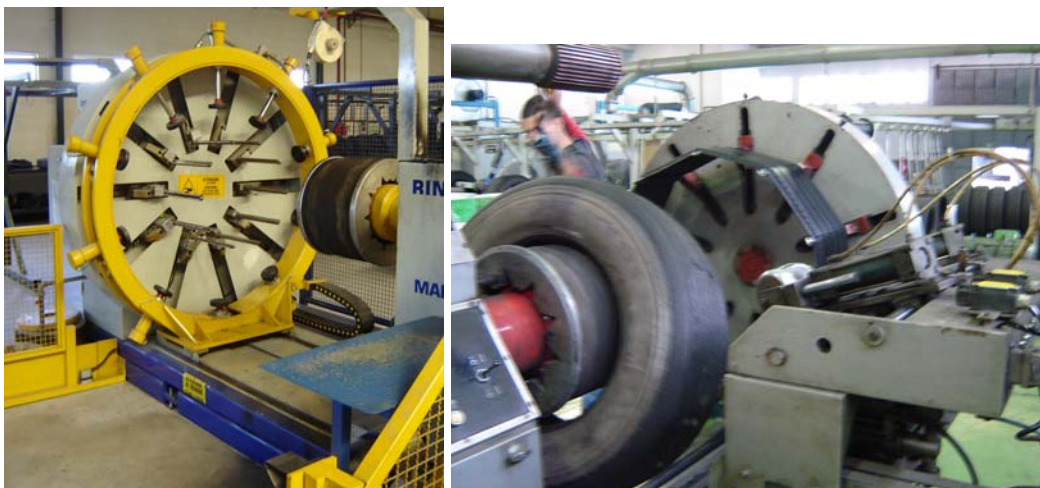
Figura 16 – Máquinas e processo de aplicação do piso “ringtread”
