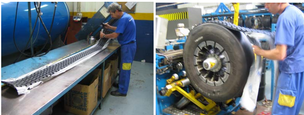
Figura 10 – Preparação do piso e aplicação no pneu (processo “a frio”)
