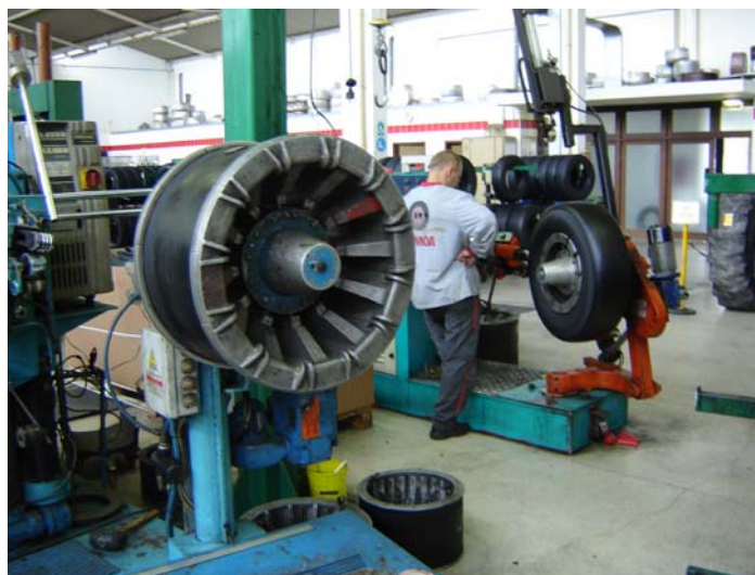
Figura 11 - Aplicação do piso no processo “a quente”
