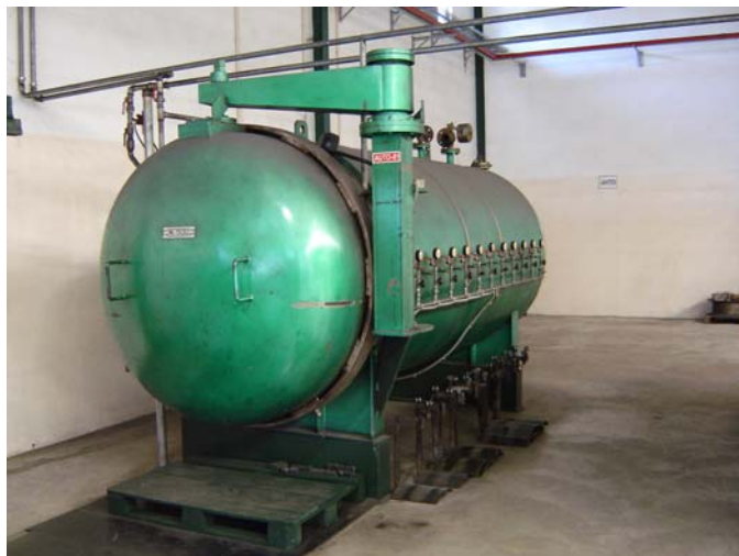
Figura 12 - Vulcanização em autoclave (processo “a frio”)
