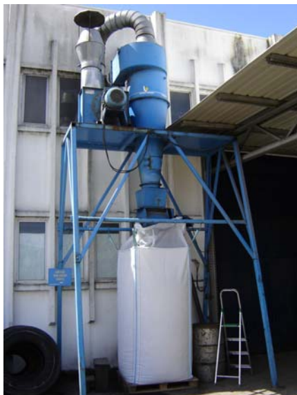
Figura 8 - Sistema de filtração e precipitação do pó da borracha
