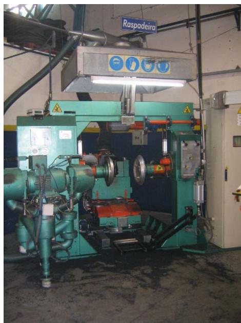
Figura 7 - Raspagem do piso e sistema de aspiração do pó de borracha
