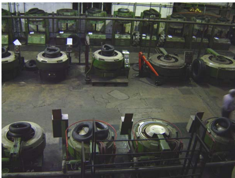
Figura 13 - Vulcanização em prensas (processo “a quente”)
